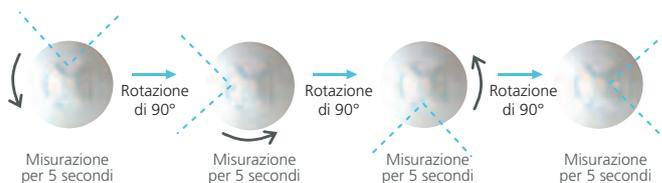
*Il sensore ruota lentamente ad intervalli di 5 secondi per misurare la temperatura*
