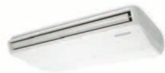
I sistemi di climatizzazione **Split System Mitsubishi Electric serie PCZ-RP** a pompa di calore sono disponibili in cinque grandezze con capacità nominali da 4,7 a 16,0 kW. Caratterizzati da un funzionamento particolarmente silenzioso, sono dotati di un filtro ad alta efficienza e una batteria ad espansione diretta, adatti per l'**installazione a soffitto a vista**.
