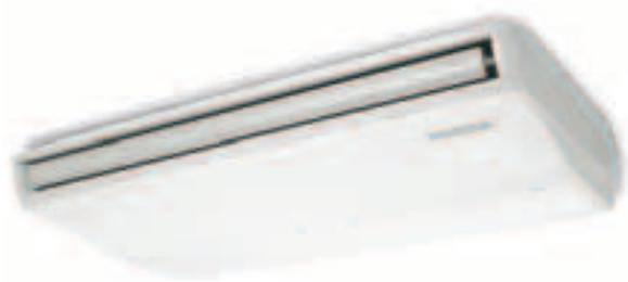
I sistemi di climatizzazione **Split System Mitsubishi Electric serie PCZ-P** a pompa di calore sono disponibili in cinque grandezze con capacità nominali da 4,9 a 16,0 kW. Caratterizzati da un funzionamento particolarmente silenzioso, sono dotati di un filtro ad alta efficienza e una batteria ad espansione diretta, adatti per l'**installazione a soffitto a vista**.
