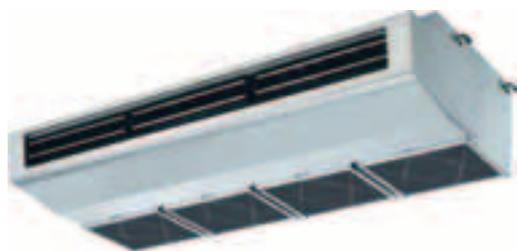
I sistemi di climatizzazione **Split System Mitsubishi Electric serie PCZ-RP** ha pompa di calore sono disponibili in due grandezze con capacità nominali da 7,1 a 12,5 kW. Caratterizzati da un funzionamento particolarmente silenzioso, sono dotati di un filtro ad alta efficienza e una batteria ad espansione diretta, adatti per l'**installazione a soffitto a vista**.
