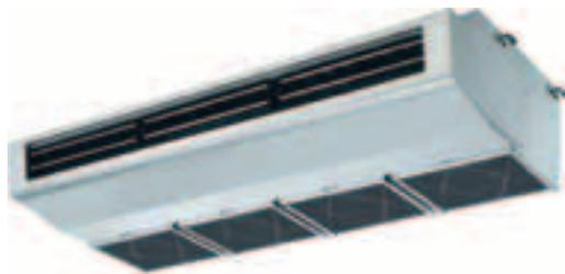
I sistemi di climatizzazione **Split System Mitsubishi Electric serie PCH-P** a pompa di calore sono disponibili in due grandezze con capacità nominali da 7,6 a 12,5 kW. Caratterizzati da un funzionamento particolarmente silenzioso, sono dotati di un filtro ad alta efficienza e una batteria ad espansione diretta, adatti per l'**installazione a soffitto a vista**.
